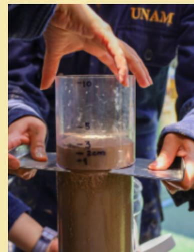
Proceso en el que se secciona un núcleo por niveles (0-1 cm, 1.1-3 cm y de 3.1-5 cm)
