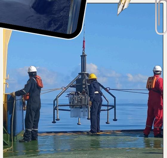
Descenso del multinucleador para la colecta de muestras del sedimento abisal
